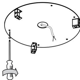
Passes os cabos de alimentação da rede elétrica pelo furo central da base da canopla
