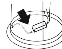
Conecte o cabo vermelho no Led + e o cabo preto no Led - do driver
