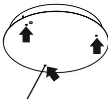
Passes os cabos de aço nos furos do acabamento da canopla
