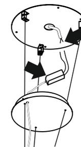
Com a rede elétrica desligada, conecte os cabos do driver e isole com fita isolante anti-chamas.
