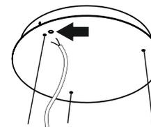
Passes o cabo de alimentação da luminária pelo niple do acabamento da canopla.
